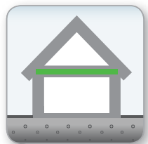
DECKENDÄMMUNG in die oberste Geschoßdecke
