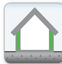
WANDDÄMMUNG Außenwand - Innenwand
