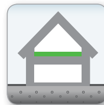
DECKENDÄMMUNG auf die oberste Geschossdecke
