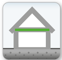
DECKENDÄMMUNG in die oberste Geschossdecke
