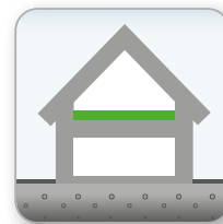
DECKENDÄMMUNG auf die oberste Geschossdecke
