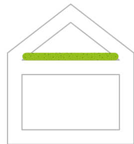
Deckendämmung: auf die oberste Geschossdecke
