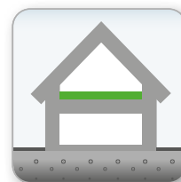
DECKENDÄMMUNG auf die oberste Geschossdecke
